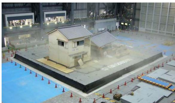
E-ディフェンスによる木造住家振動実験風景
